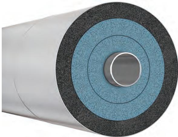
Чтобы удовлетворить уникальные требования, предъявляемые к низкотемпературным трубопроводам, криогенные системы Armaflex включают дополнительные элементы для областей применения с температурами до -200°C. Для таких применений самый внутренний слой Armaflex LTD изготавливается с антиабразивным слоем из усиленной фольги. Этот антиабразивный слой придает поверхности дополнительную прочность и обеспечивает более надежную защиту от сильных вибраций и движения труб.
