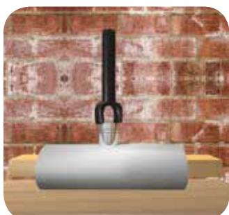
В той из них, которая предназначается для изоляции основной части трубопровода, следует проделать отверстие с помощью металлического пробойника. Диаметр отверстия должен быть на 1-2 мм больше диаметра трубы отвода.
