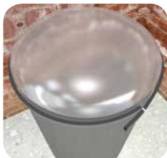
Измерьте периметр резервуара, применяя узкую полоску теплоизоляции соответствующей толщины, не растягивайте полоску! Измерьте высоту резервуара.
