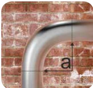
Измерьте радиус кривизны трубопровода большого сечения.
