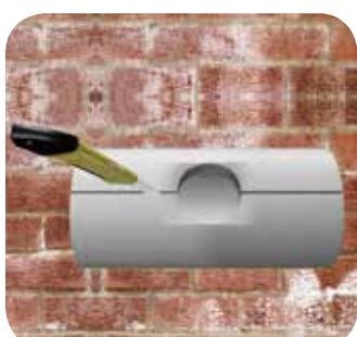
Затем разрежьте теплоизоляционную деталь, подготовленную для монтажа на основную часть трубопровода, вдоль по всей длине, проходя через центр пробитого отверстия.
