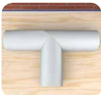
Через 2-12 минут, в зависимости от температуры окружающей среды, когда клей слегка подсохнет (он должен перестать прилипать к пальцам), соедините склеиваемые поверхности срезов.
