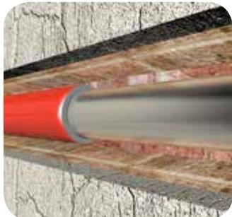
Смонтируйте теплоизоляционную трубку Thermafex Thermacompact IS соответствующего диаметра на трубопровод методом натяжения: не прикладывая больших усилий, волнообразными движениями протягивайте изоляцию по поверхности трубопровода. Натягивать изоляцию следует осторожно, не надо создавать излишнее давление - это может привести к деформации теплоизоляционной трубы.
