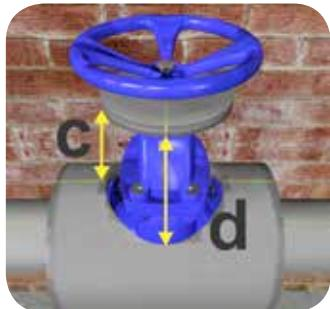
Измерьте максимальное - d и минимальное - с расстояния между изоляционным диском и цилиндрической изоляционной деталью с учетом толщины изоляции фронтального фланца.
