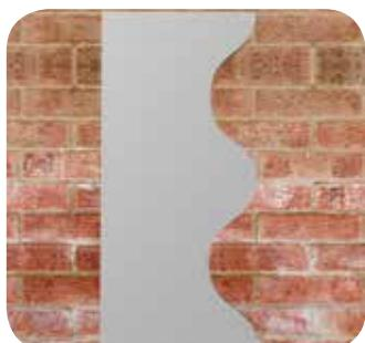
Аккуратно разрежьте теплоизоляцию по полученной кривой линии.
