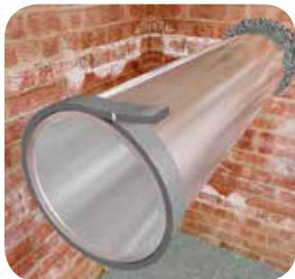
Оберните вокруг трубопровода узкую полоску теплоизоляции соответствующей толщины для измерения длины окружности изолируемого трубопровода.
