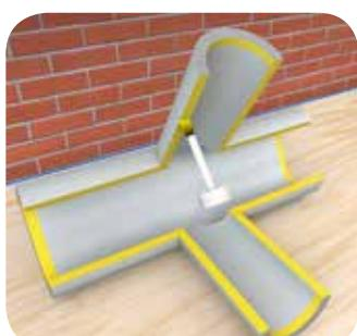
Нанесите тонкий, ровный слой клея Thermaflex на склеиваемые поверхности разреза и на части внутренней стороны изоляции, дайте слегка просохнуть.
