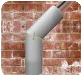
Прижмите и при необходимости зафиксируйте монтажными клипсами THERMACLIPS, затем проклейте швы лентой Терматейп СК или лентой армированной ЭКО для герметизации соединений.
