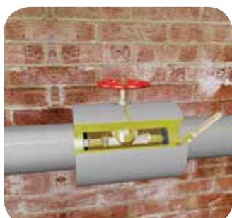
Установите полученную изолирующую деталь в соответствующее место, продев ножку крана в круглое отверстие. Тщательно склейте все места разреза и местастыковки с изоляционной подложкой, используя клей Thermaflex, прижмите.
