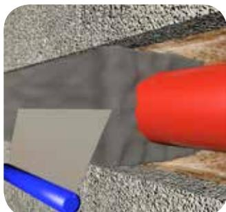
Конструкция трубопровода готова для заливки бетоном или раствором.
