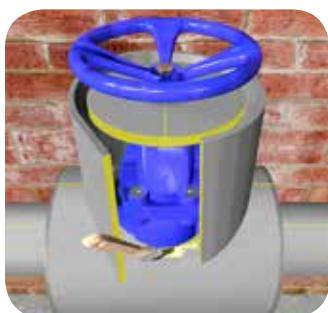
Нанесите слой клея на все соединяемые торцы теплоизоляции.
