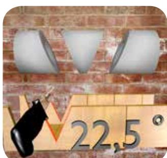
Возмите кусок трубной теплоизоляции Thermaflex достаточной длины, разрежьте на сегменты как показано на рисунке.
