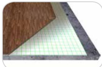
**Вариант №1:** Для того, чтобы смонтировать систему «теплый пол», на ровную бетонную стяжку положите теплоизоляционные листы Thermasheet FL требуемого размера, склеив между собой алюминиевым скотчем, как показано на рисунке, сверху уложите напольное покрытие.
