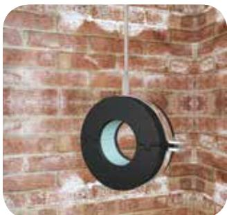
Для того, чтобы избежать смятия теплоизоляции в местах опирания трубопровода, удобства монтажа, и, чтобы уменьшить теплопотери через конструкционные элементы крепления, используют подвесы для труб. Внутренние диаметры подвесов соответствуют самым распространенным диаметрам труб.
