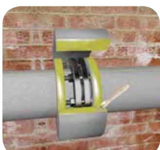
Оберните фланец прямоугольником из теплоизоляции и склейте все соединения.
