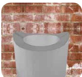
На меньшем отрезке, предназначенном для отвода Т-образного соединения, произведите U-образный вырез с торца изоляционной трубы, как показано на рисунке. Разрежьте вдоль для монтажа на трубопровод.
