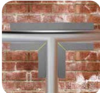
Для монтажа изоляции на Т-образном соединении труб равного диаметра необходимо взять трубную теплоизоляцию подходящего размера, затем разрезать её на два куска, один из которых будет занимать треть всей длины трубы, а второй - две трети.
