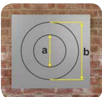
Нанесите полученные размеры на лист тепловой изоляции как показано на рисунке.
