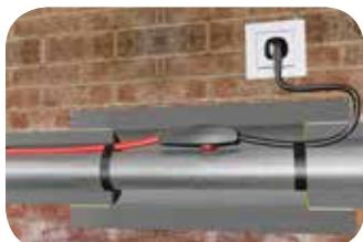
По окончании монтажа Thermalint евровилку греющего кабеля подключить к розетке с заземляющим проводом напряжением 220 В.
