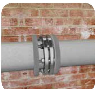
Измерьте периметр, применяя полоску Thermasheet требуемой толщины (равной толщине смонтированной на трубопровод теплоизоляции), затем вырежьте полоску требуемой ширины, равной расстоянию между кольцами, которое можно измерить линейкой.
