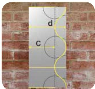
Отложите по размеченным линиям измеренные максимальные и минимальные расстояния между изоляционным диском и цилиндрической изоляционной деталью: на рисунке им соответствуют длинные d и короткие желтые с линии. Используя разницы высот как радиус, проведите пять полуокружностей с центрами на концах отрезков, затем проведите плавную линию, соединяющую все дуги окружностей.
