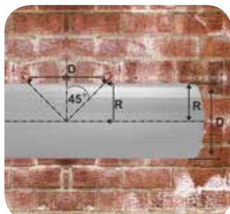
На середине большого отрезка, предназначенного для изоляции основной части трубопровода Т-образного соединения, произведите разметку для двух разрезов по  $45^\circ$  так, чтобы расстояние  $D$  было равным внешнему диаметру трубной изоляции, а глубина разреза - радиусу.
