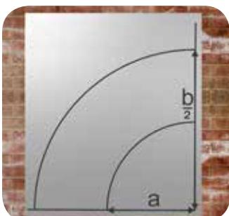
Разметьте лист изоляции как показано на рисунке, используя циркуль и линейку.
