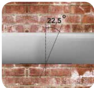
Возьмите кусок трубной изоляции нужного размера для изоляции изгиба трубопровода 45°. Отмерьте угол, равный 22,5°, проведите разрез трубы.
