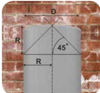
Разрежьте полученную изоляционную деталь, как показано на рисунке, по всей длине, проходя через центральную точку произведенного ранее V-образного выреза.
