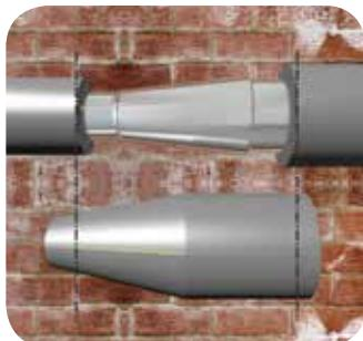
Затем укоротите полученную изоляционную деталь так, чтобы внутренний диаметр конусообразной части соответствовал размерам узкого участка трубопровода.
