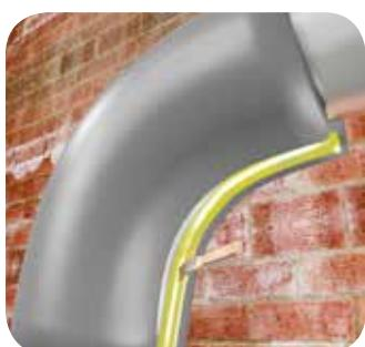
Смонтируйте полученное изоляционное колено на трубопровод, нанесите клеевой слой на торцевые поверхности меньшего радиуса, дайте слегка просохнуть, прижмите.
