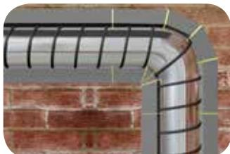
Проведите монтаж теплоизоляции на трубопровод.
