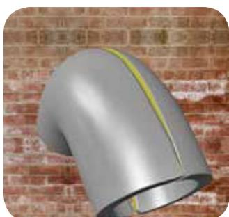
После того, как клей слегка подсохнет, постепенно прижимайте торцы теплоизоляционных деталей друг к другу от краев к центру, чтобы избежать перекосов. Особенно тщательно проклейте центральную часть шва.
