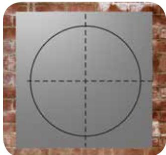
Разметьте лист изоляции, используя полученные размеры, или склейте при необходимости несколько листов, если площадь поверхности превышает размеры теплоизоляционного листа. Аккуратно вырежьте изоляционную деталь по контуру.
