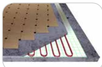
**Вариант №2:** На ровную бетонную стяжку настелите теплоизоляционные листы Thermasheet FL, склеив между собой алюминиевым скотчем Thermaflex. Затем сверху смонтируйте электрическую систему теплого пола на основе нагревательного кабеля, либо систему отопительных трубок, затем сверху сделайте бетонную стяжку и положите напольное покрытие.
