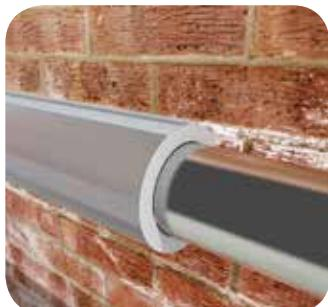
Расстегните замок-защелку на теплоизоляционной трубке Thermaflex Ultra M подходящего диаметра. Для этого отогните край материала таким образом, чтобы освободить верхнюю часть замка, тогда он будет открываться очень легко продвижением большого пальца или тупого предмета между разделяющимися частями. Смонтируйте на трубопровод и аккуратно застегните защелку, начиная от одного конца трубы к другому, чтобы избежать перекосов.
