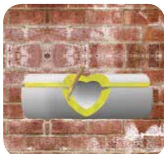
На меньшем отрезке, предназначенном для теплоизоляции отвода Т-образного соединения, произведите разметку для двух разрезов по  $45^\circ$ , но уже с торца трубной изоляции, как показано на рисунке.
