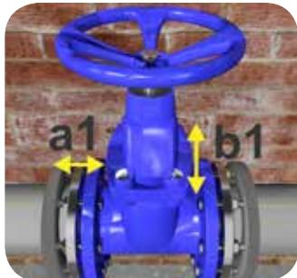
Вырежьте два изоляционных кольца необходимого размера и смонтируйте кольца у внешних сторон каждого из фланцев, соединив разрезанные концы с помощью клея Thermaflex. Более подробное описание вы можете найти в пункте «Утепление фланцевого соединения». Измерьте расстояние между наружными поверхностями установленных на фланцах изоляционных колец, затем определите длину окружности фланцев с помощью полоски изоляции соответствующей толщины.
