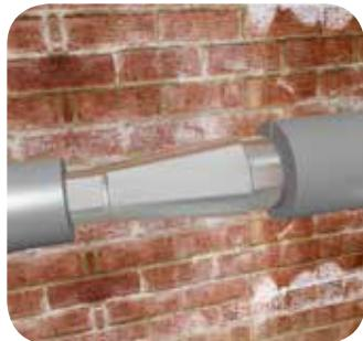
В случае редукции, при наличии на трубопроводе участков переменного сечения, начните монтаж с прямых участков трубопровода.
