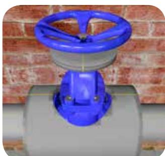
Проведите измерения диаметра фланца на фронтальной части вентиля и размеры и форму крышки штока вентиля, нанесите полученные размеры на лист теплоизоляции и вырежьте диск.
