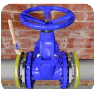
Нанесите тонкий, ровный слой клея Thermaflex на торцы изоляционных колец, установленных на фланцах, подождите, пока клей слегка подсохнет (он не должен приставать к пальцам).
