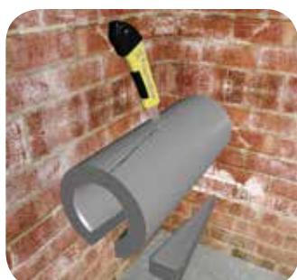
Вырежьте два V-образных сегмента с одного конца теплоизоляционной трубы напротив друг друга.
