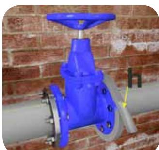
Измерьте диаметр трубы с изоляцией с помощью узкой полоски теплоизоляции.
