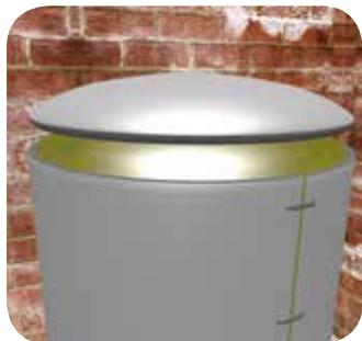
Нанесите тонкий, ровный слой клея Thermaflex на всю поверхность вырезанной детали.
