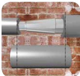
Отрежьте кусок теплоизоляционной трубы с внутренним диаметром, равным внешнему диаметру большего участка трубопровода, и длиной, превышающей изолируемый участок, на 2-3 см.
