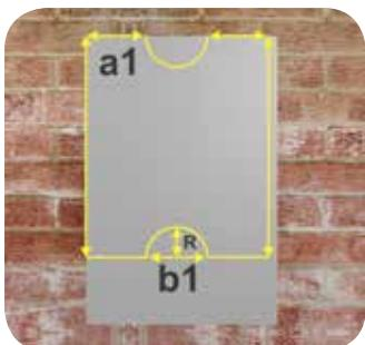
Измерьте диаметр горловины вентиля и нанесите полученные размеры на лист теплоизоляции.
