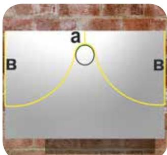
Разметьте лист изоляции как показано на рисунке, где ширина листа равна длине окружности изоляционного кольца, расстояние *a* необходимо отложить ровно посередине изоляционного листа. Затем проведите дуги окружностей, радиус центральной окружности будет равен четверти диаметра изолированного вентиля. Проведите плавную кривую, соединяющую дуги окружностей, и вырежьте изоляционную деталь.
