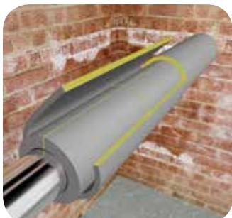
Проведите изоляцию трубопровода в зависимости от его диаметра трубной или листовой теплоизоляции Thermaflex, см. пункты «Монтаж трубной изоляции Thermaflex на прямых участках трубопровода» или «Монтаж листовой изоляции Thermaflex на прямых участках трубопровода», очистите поверхность первого слоя теплоизоляции от грязи, пыли, жира.
