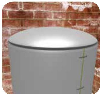
После того, как клей слегка просохнет (он должен перестать прилипать к пальцам), смонтируйте деталь на крышке резервуара.
