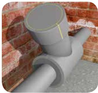
Склейте из полученных деталей цилиндрическую съемную крышку.
