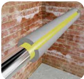
Оберните листовой теплоизоляцией трубопровод, нанесите kleевой слой на внутреннюю поверхность теплоизоляции (на глубину 20 мм) в местах присоединения к трубопроводу и соедините обработанные kleem поверхности, начиная от края листа к середине, чтобы избежать перекосов. Прижмите.
