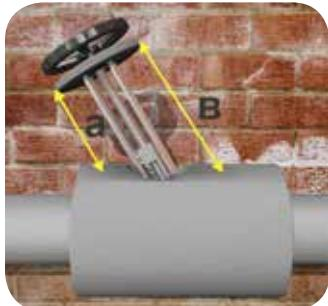
Измерьте расстояния *a* и *b* от смонтированного кольца до изоляции фланцев вентиля.
