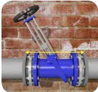
Произведите монтаж изоляции на прямых участках трубопровода до вентиля. Вырежьте два изоляционных кольца необходимого размера и смонтируйте кольца у внешних сторон каждого из фланцев, соединив разрезанные концы с помощью клея Thermaflex. Более подробно см. пункт «Утепление фланцевого соединения». Затем измерьте расстояния между внешними поверхностями смонтированных изоляционных колец, а также от поверхности каждого кольца до горловины вентиля.
