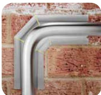
Изоляционные покрытия Thermaflex режут на сегменты и используют их при монтаже в тех случаях, когда их невозможно протолкнуть через колена (большой диаметр или толщина), а также в случаях большого радиуса изгиба трубопровода, значительно превышающего диаметр трубы.
